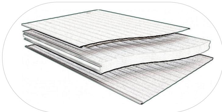
Пенополиуретан состоит из мелких закрытых ячеек. 3% в его объеме занимает твердый материал, 97% — поры, заполненные газом, а их плотность обычно варьируется в пределах 24—96 кг/м<sup>3</sup>.
