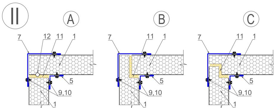
Варианты крепления стеновых и потолочных панелей
