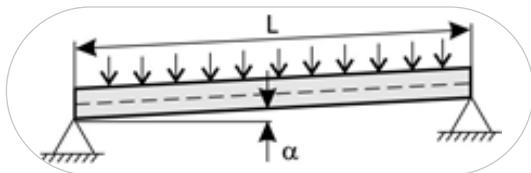
Обратите внимание, что воздействие нагрузки, характеризующейся представленными в таблице 25 значениями, не приводит к разрушению кровельной панели, а лишь вызывает ее прогиб на 1/200 длины. Поскольку они рассчитывались для горизонтальной плоской кровли, то, если кровля имеет наклон под углом  $\alpha$ , их необходимо умножить на  $\cos \alpha$ .
