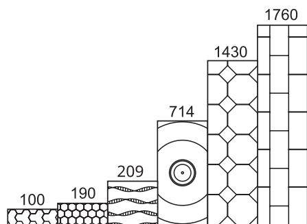
Все строительные материалы при указанной в таблице толщине обладают одинаковым сопротивлением теплоотдаче  $4,76 \text{ м}^2\text{K/Bt}$ .
