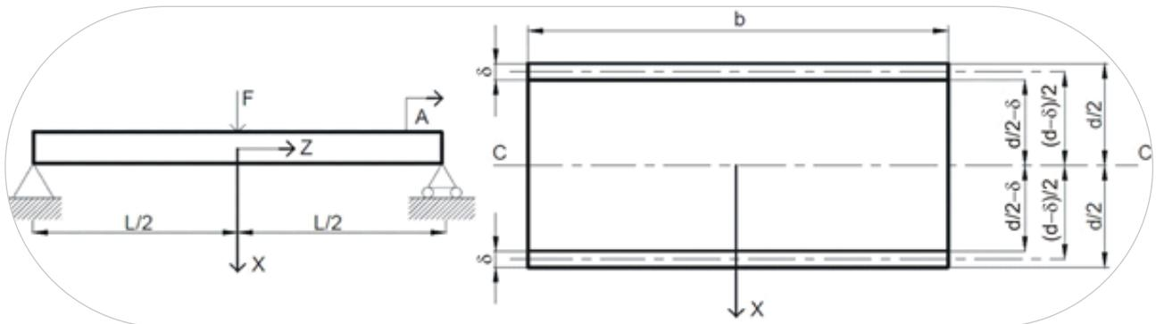
Первое слагаемое в выражении соответствует изгибной жесткости листов металлической обшивки относительно их центральной оси, второе представляет собой изгибную жесткость металлических листов относительно центральной оси панели, третье описывает жесткость полиуретановой сердцевины относительно ее оси, которая, в принципе, совпадает с центральной осью панели. Первое слагаемое в выражении (10) составляет менее 1% второго, если выполняется следующее условие:
