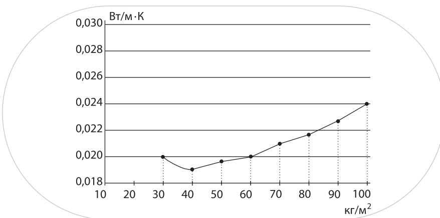
Как видно из графиков, лучшими теплоизоляционными свойствами обладает ППУ плотностью около  $40 \text{ кг}/\text{м}^3$ . Далее будет показано, что образцы панелей с наполнителем такой плотности также имеют достаточную конструктивную жесткость.
