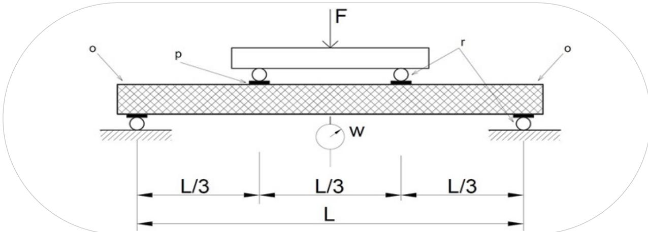
$F$  — приложенная сила,  $r$  — валики радиусом 15 мм,  $w$  — измеряемый изгиб панели,  $p$  — грузораспределительные пластины толщиной 8–12 мм и шириной  $L_s$ ,  $o$  — выпуск испытуемой панели, не превышающий 50 мм.
