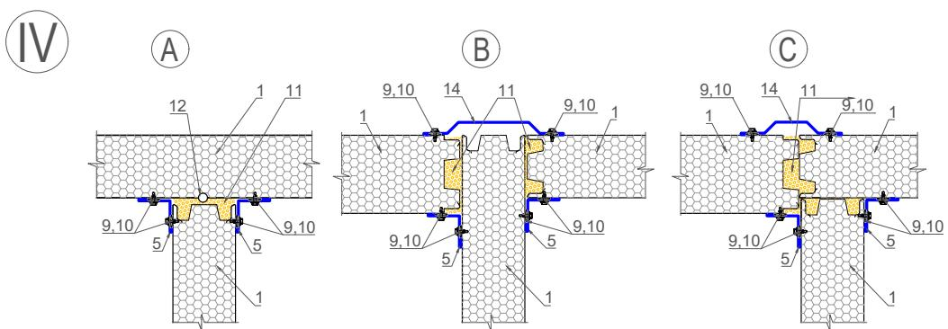
Варианты крепления перегородочных панелей к потолочным
