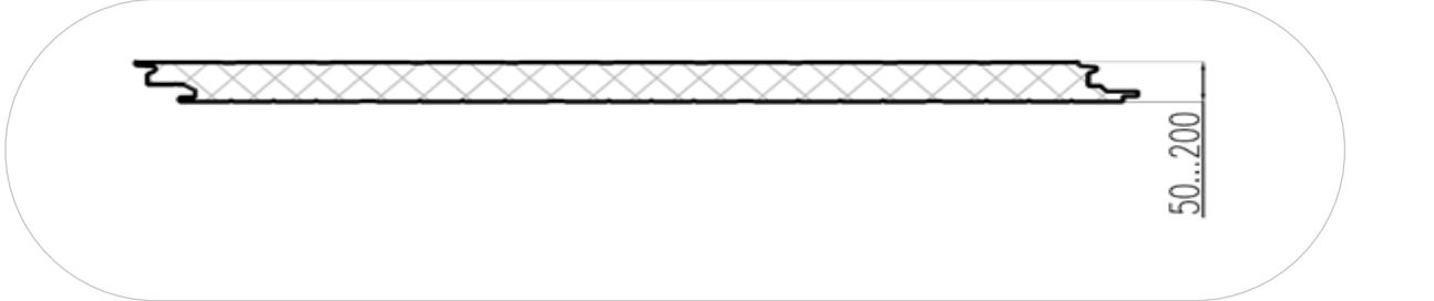
Формы стыковочных замков надежно соединяют металлический лист с полиуретановым сердечником благодаря тому, что в «пазовой» части край металлического листа пронизывает средний слой.
