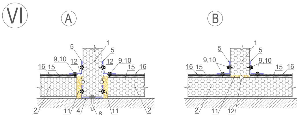
По периметру камеры к заранее выровненному полу с помощью анкеров прибиваются направляющие для стеновых панелей.
