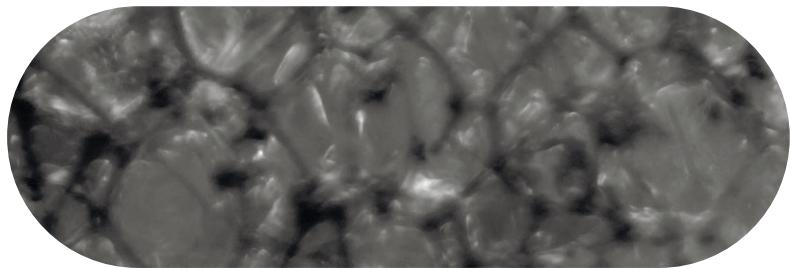
Помимо того, что жесткие ППУ обеспечивают прекрасную теплоизоляцию, они достаточно твердые и выдерживают значительные механические нагрузки, поэтому ППУ активно применяются для в качестве среднего слоя в сэндвич-панелях.
