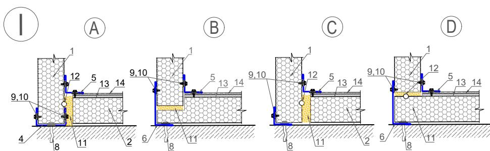
Варианты крепления стеновых панелей в углах камеры
