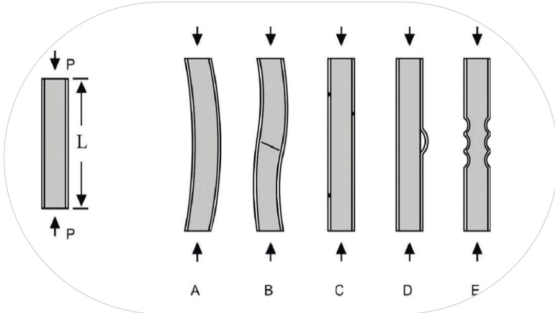
Будем считать панель идеально ровной. Так как жесткость ее металлической обшивки во много раз превосходит жесткость сердцевины из вспененного полиуретана, то,
